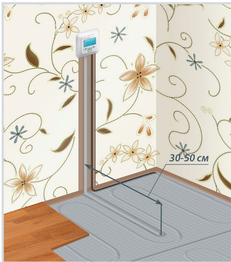
Схема укладки датчика температуры в гофрированной трубке
